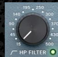
**HP FILTER** – Das charaktervolle Hochpassfilter, das im Englischen *high pass filter* heißt, besitzt eine 12 dB/Okt steile Filterflanke.
