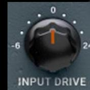
INPUT DRIVE erhöht die Pegelstärke im Transformator und erzeugt eine *Obertonabbildung geradzahlgiger Ordnung*, die im Englischen *even order harmonics* heißt.
