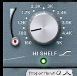
Der Filterschaltkreis arbeitet wahlweise als HI SHELF: Einem *Hochfrequenzfilter mit Kuhschwanz-charakteristik*, oder als BELL FILTER: Einem *Glockenfilter mit Proportional-Q-Charakteristik*. Um den Filtertyp zu wechseln, klicken Sie bitte auf die Beschriftung unterhalb des Reglers.
