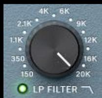
Das charaktervolle Tiefpassfilter (*low pass filter*) besitzt eine 12 dB/Okt steile Filterflanke. Je nach Samplingrate ändert sich die Maximalfrequenz wie folgt:
