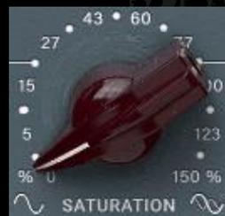
Der SATURATION-Schaltkreis sättigt ihre Tonspuren bis zur Verzerrung und dickt sie auf organische Weise an. Drehen Sie den Regler im Uhrzeigersinn, entstehen zunehmend komplexe Obertonmuster; und die setzen sich zusammen aus der Originaltonspur und einem sich
