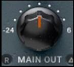
Der MAIN OUT-Regler verstärkt den Signalpegel entweder digital-ungefärbt oder senkt ihn ab.
