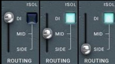
Mit dem ROUTING-Schalter wechseln Sie zur Kanalbearbeitung von Mono DI (Stereo), MID (Signalmitte) oder SIDE (Seiteninformation).
