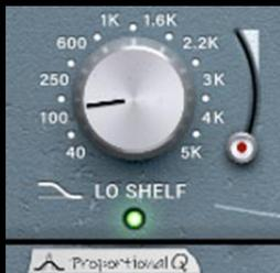
Der Filterschaltkreis arbeitet wahlweise als LO SHELF: Einem *Niederfrequenzfilter mit Kuhschwanzcharakteristik*, oder als BELL FILTER: Einem *Glockenfilter mit Proportional-Q-Charakteristik*. Um den Filtertyp zu wechseln, klicken Sie bitte auf die Beschriftung unterhalb des Reglers.
