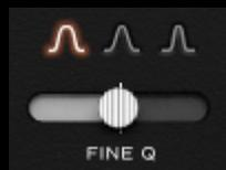
Le facteur Q définit la largeur et la pente du boost/cut. Le sélecteur LOW Q permet de choisir l'un des trois modèles Q proportionnels réglés individuellement.
