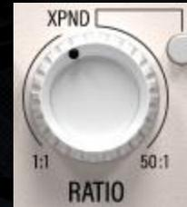
RATIO determina el factor por el cual se ajusta la ganancia una vez que la señal S/C cruza la línea umbral. La reducción de ganancia (ganancia en modo XPND) se aplica a la señal de entrada.
