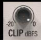
Nada debe pasar. El potenciómetro CLIP establece el valor RMS dBFS (decibelios en relación con la escala completa) en el que el clipper analógico recorta la señal con un clipping de calidad cristalina y bellamente transparente. Al igual que con los circuitos clipper analógicos imperfectos del mundo real, los rebasamientos a veces pueden ocurrir aleatoriamente dentro de una tolerancia de +0.3 dB. Nada más que un rasguño.
