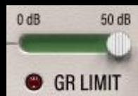
Limita la reducción máxima de ganancia al valor especificado. Sin esta función, el compresor o expansor/compuerta aplicará la reducción de ganancia según lo determinado por la relación y el umbral sin restricciones. Con esta función, la reducción de ganancia no superará este valor.
