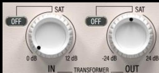
Les boutons de gain T. IN et T. OUT permettent de régler le gain avant et après le traitement dynamique soit numériquement de façon propre et
