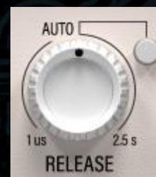
Le paramètre RELEASE contrôle le temps nécessaire pour revenir au niveau de gain non affecté lorsque le signal tombe en dessous du threshold.
