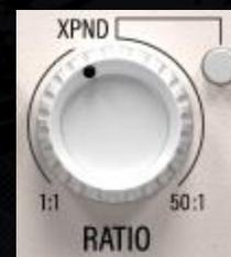
RATIO détermine le facteur par lequel le gain est ajusté une fois que le signal S/C franchit le threshold. La réduction du gain (gain en mode XPND) est appliquée au signal d'entrée.
