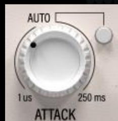
ATTACK contrôle le temps nécessaire pour atteindre le réglage de gain ciblé en fonction des réglages de threshold et de ratio.
