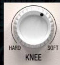
Il KNEE è la pendenza (linearità della transizione) della ratio. Nell'impostazione SOFT, il rapporto viene gradualmente aumentato fino a raggiungere il valore di ratio impostato, mentre nell'impostazione HARD, il valore di ratio viene applicato immediatamente.
