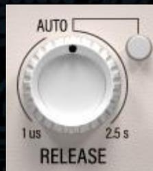
RELEASE controlla il tempo necessario per ripristinare completamente il livello di guadagno inalterato una volta che il segnale scende al di sotto della threshold.
