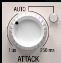
ATTACK controlla il tempo necessario per raggiungere completamente la riduzione del guadagno in base alle impostazioni di threshold e ratio.
