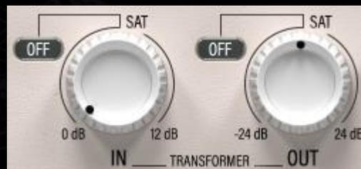
Le manopole di guadagno T.IN e T.OUT forniscono amplificatori accoppiati con trasformatore digitalmente pulito o con mojo per la regolazione del guadagno pre e post elaborazione dinamica.
