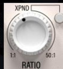
RATIO determina il fattore in base al quale il guadagno viene regolato una volta che il segnale S/C attraversa la threshold. La riduzione del guadagno (o aggiunta di guadagno in modalità XPND) viene applicata al segnale di ingresso.
