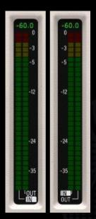
LED メーターは、ピーク値と RMS の入出力 レベルを同時に表示し、RMS は、メーター のメイン部分にある LED ブロックで表され、 ピークは、RMS ブロックの上に常に表示さ れるホールド LED ライトで表示されます。
