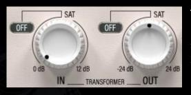
T.IN および T.OUT ゲイ ンノブは、ダイナミック 処理前後のゲイン調整に 対して、どちらかという と洗練されたデジタル的 なクリーンなアンプまた
