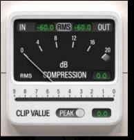
dB コンプレッションゲインリダクションメーターのメインウィンドウは、信号に適用されたRMS(Root-Mean-Square)ゲインリダクションが、針で表示されます。
