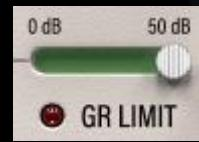
将最大的增益降低限制在指定的数值内。如果没有这个设置，压缩器或扩幅器/门将不受限制地应用由比率和阈值决定的增益降低。有了这个设置，增益降低将不会超过这个值。
