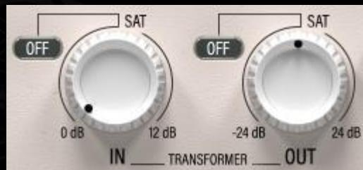
*T.IN* 和 *T.OUT* 增益旋钮提供了清澈无音染数字型或充满魔力的变压器耦合放大器, 用于调整动态处理之前和之后的增益。
