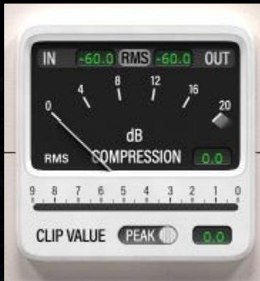
**dB COMPRESSION** 增益削减表主窗口显示应用于信号的 RMS (均方根) 增益减弱，由弹道指针指示。针的右边是一个显示框，显示针所显示的数值的数字表示。
