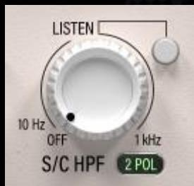
S/C HPF 对检测器电路应用了一个高通滤波器。这个滤波器并不直接影响处理后的信号的声音。
