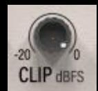
没有信号可以通过。CLIP 旋钮设置了 dBFS（相对于满刻度的分贝）RMS 值，在这个值上，模拟削波器对信号进行顶级质量且干净的硬削波处理。与现实世界中不完美的模拟削波电路一样，过冲有时会在+0.3dB 的公差范围内随机发生。这只是一个小小的问题。
