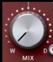
**MIX WET/DRY** ノブは、処理された Wet 信号に未処理の Dry 信号をブレンドします。
