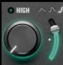
Hinweis: Selbst, wenn Sie ein EQ-Band in den Bypass versetzen, werden dessen Klangmerkmale auch weiterhin vom Fairuz bearbeitet – allerdings mit einer Verstärkung von 0 dB, was bedeutet: Die Sättigung des Operationsverstärkers wirkt auch dann auf eine um 12 dB angehobene Frequenzposition, wenn Sie das EQ-Band zuvor in den Bypass versetzt haben. Dann allerdings bleibt die Signalverstärkung bei 0 dB – die Lautstärke wird also nicht verändert, obwohl das EQ-Band um 12 dB angehoben wurde.
