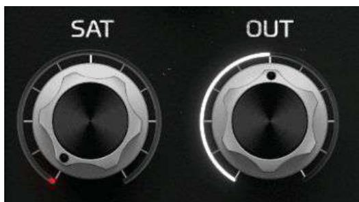
SAT P42 サチュレーションは、OUTPUT モジュールに到達する信号に適用されます。これは WET 信号に適用され、ドライ信号には適用されません。
