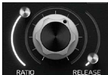
Tip: P930 をコンプレッサーとして使用します！ BBD および PLATE REVERB モジュールをバイパスし、DKG 回路を DUCK に設定し、DKG ルーティングオプションを OUT に設定します。MIX ノブを使用して生の信号とブレンドし、お好みで調整します。また、OUT ノブを使用して圧縮された信号レベルを増加させることもできます。さらに、SAT ノブを使用して圧縮された信号にサチュレーションを追加することもできます！
