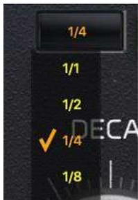
Time Subdivision は、Pre-Delay 時間を音楽的なタイムインターバルに分割して遅延時間を設定します。PRE-DELAY ノブは、異なる Time Subdivision を選択しても位置は変わりません。たとえば、 $\frac{1}{4}$  で 20ms の Pre-Delay が設定されている場合、 $\frac{1}{8}$  では 10ms、 $\frac{1}{2}$  では 40ms になります。
