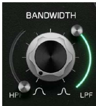
BANDWIDTH、HPF、LPF は連携して、モジュールの処理された (WET) 信号用のバンドパスフィルターを形成します。HPF と LPF がフィルターのエンドを設定し、BANDWIDTH ノブがそれを微調整して、ミックスに完璧にフィットするエフェクトを作り出します。
