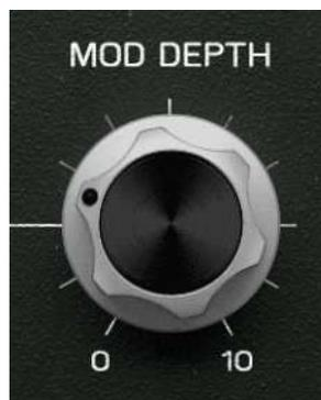
Modulation Depth ノブは、Delay に適用される LFO の振幅を制御し、ピッチ変化の量に影響を与えます。このノブがゼロの状態では、Modulation Rate だけでは信号に影響を与えることはできません。
