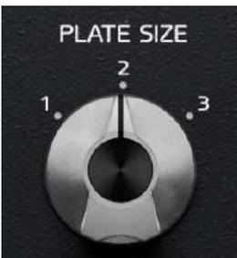
PLATE SIZE セレクタは、1980 年代初頭の高級デジタルエフェクターに見られる 3つのプレートデザイン (Small、Medium、Large) を切り替えます。
