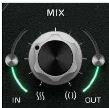
Polarity Flip は、MIX ノブの前で信号の極性を反転させます。極性を反転させることで、Delay Line の位相問題を修正したり、意図した効果を強調したり、サウンドデザインでのクリエイティブな可能性を広げることができます。
