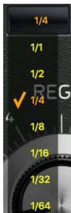
Time Subdivision は、Clock Rate の速度を音楽的な時間間隔に分割してディレイ時間を設定します。異なる時間のサブディビジョンを選択しても、Clock Rate ノブの位置は変わりません。例えば、500ms の Clock Rate で 1/4 を設定すると、1/8 では 250ms、1/2 では 1000ms になります。
