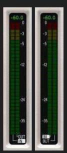
Der LED-Pegelmeter zeigt gleichzeitig die PEAK-Messung (Spitzenpegel) und die quadratisch gemittelte Lautstärke, RMS (engl.: root mean square), des Eingangsund Ausgangssignals. Die RMS-Messung wird fortlaufend neu berechnet und als tanzender LED-Block dargestellt. Die PEAK-Messung wird durch ein einzelnes LED-Kästchen repräsentiert. Es verweilt solange über dem LED-Block, bis ein höherer PEAK-Wert ermittelt wird. Der Zahlenwert in der Kopfzeile des Pegelmeters entspricht der PEAK- oder
