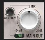
Mit dem WET DRY-Mischer mischen Sie dem Nass-Signal das Trockensignal hinzu. Die Position des WET DRY-Mischers im Signalpfad ändern Sie mit dem Schalter für PRE und POST. Stellen Sie ihn auf PRE, fließt das vom MIX WET/DRY- Mischer
