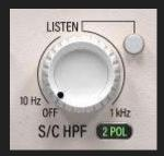
Mit dem S/C HPF-Regler betreiben Sie das Hochpassfilter des Sidechain-Detektors. Das Filter selbst ist unhörbar und hat keine Auswirkung auf den Klang. Wie steil die Filterflanke ist wählen Sie mit dem 1-POL/2-POL-Schalter. Das einpolige Filter
