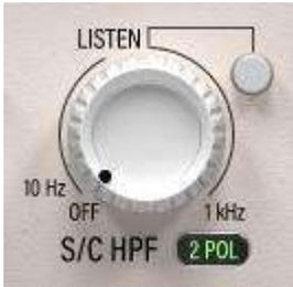
Mit dem S/C HPF-Regler betreiben Sie das Hochpassfilter des Sidechain-Detektors. Das Filter selbst ist unhörbar und hat keine Auswirkung auf den Klang. Wie steil die Filterflanke ist wählen Sie mit dem 1-POL/2-POL-Schalter. Das einpolige Filter
