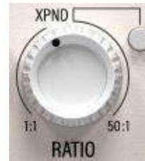
Die RATIO bestimmt, in welchem Umfang der Pegel eines Signals dynamisch reduziert wird, was im Sidechain-Detektor stattfindet, sobald das Signal den Schwellenwert überschreitet (engl.: threshold).
