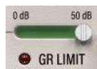
GR ist die Abkürzung des englischen Begriffs gain reduction, was Pegelreduktion heißt. Mit dem GR LIMIT-Schieberegler beschränken Sie die Pegelreduktion auf ein Höchstmaß. Ohne diese Obergrenze würde der Kompressor (oder Expander und Gate) den Signalpegel uneingeschränkt reduzieren. Setzen Sie eine Obergrenze, untersagen Sie dem Abyss aufs Strengste, darüber hinaus zu komprimieren. Überschreitet ein Signal die Grenze, blinkt das rote Lämpchen und Sie finden schnell eine gute Einstellung.
