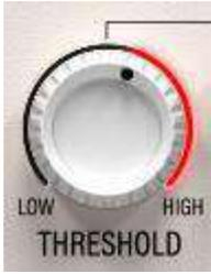
Mit dem THRESHOLD-Regler stellen Sie den Schwellenwert des Kompressors ein. Sobald ein Signal im Sidechain-Detektor diese Schwelle überschreitet, greift der Kompressor zu. Die Stärke der Kompression ist zudem abhängig von der RATIO. Erst im internen Sidechain-Detektor wird ein signal
