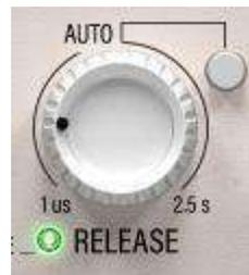
Mit dem RELEASE-Regler legen Sie die Zeitspanne fest, in der der Kompressor den Urzustand des Signals wieder herstellt, nachdem es den Schwellenwert überschritten hat und komprimiert wurde. Nach einem Klick auf den Knopf der AUTO ATTACK-Schaltkreis das anliegende Klangmaterial automatisch, wird programm- abhängig, und
