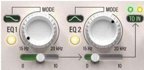
Die beiden multi-funktionalen EQ-Bänder können zwei Signale gleichzeitig bearbeiten: Das in die Sidechain-Detektoreinheit fließende Signal (TO SC) und das die Bearbeitungskette durchfließende Signal, bevor es komprimiert wird (TO IN).
