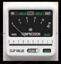
La ventana principal del medidor de reducción de ganancia dB COMPRESSION muestra la reducción de ganancia RMS (Root-Mean-Square) aplicada a la señal según lo indicado por la aguja balística.
