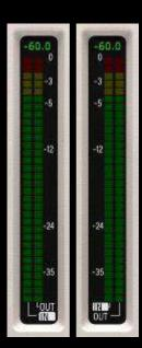
El medidor LED muestra los niveles pico y RMS de entrada y salida simultáneamente, con RMS representado como el bloque LED "sólido" actualizado continuamente en la parte principal del medidor, y con el pico representado por la luz LED "retenida", que siempre aparecerá sobre el bloque RMS.
