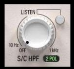
S/C HPF aplica un filtro pasa alto sobre el detector del circuito. Este filtro no afecta directamente al sonido de la señal procesada.
