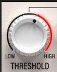
THRESHOLD は、ゲイン調整が適用されるレベルを設定できます。サイドチェイン信号(S/C)がスレッシュホルドレベルを超えると、RATIO ノブによって決定される比率で入力信号に対してコンプレッションが適用されます。
