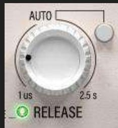
RELEASE は、シグナルがスレッシュホールドより下回った場合に、影響を受けていないゲインレベルに完全に回復するまでの時間を調整するものです。AUTO がオンになっている場合、RELEASE は Abyss によって継続的かつ動的に決定されます。プログラムに
