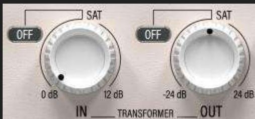
T.IN および T.OUT ゲインノブは、ダイナミック処理前後のゲイン調整に対して、どちらかという洗練されたデジタル的なクリーンなアンプまたは魅力的な効果のあるトランスフォーマーアンプを提供します。
