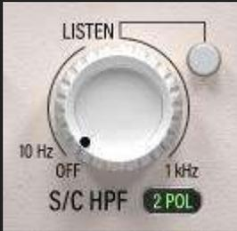
S/C HPF は、検出回路にハイパスフィルターを適用します。このフィルターは、処理された信号の音に直接影響を与えるわけではありません。S/C HPF ラベルの右にある 1 POL / 2 POL スイッチを使用すると、HPF のスロープを調整できます。
