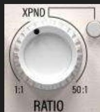
RATIO は、S/C 信号がスレッシュホルドを超えた時に増幅が調整される比率を決定するパラメータです。このゲインリダクション (XPND モードでのゲイン)は、入力信号に適用されます。
