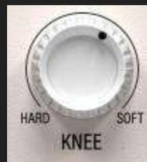
KNEE は、RATIO の傾き(移行の滑らかさ)です。SOFT では、設定した RATIO 値に達するまで徐々に上げ、HARD 設定では、設定した RATIO 値がすぐに適用されます。
