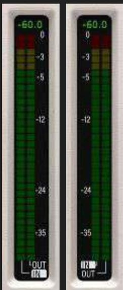
LED メーターは、ピーク値と RMS の入力レベルを同時に表示し、RMS は、メーターのメイン部分にあたるソリッド LED ブロックで表示され、ピークはホールド LED ライトで表示され、常に RMS ブロックの上に表示されます。
