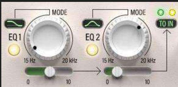
2つの多機能EQバンドは、S/Cに送られる信号を変化させるEQ (TO SC)とダイナミクス調整前の信号を変化させるEQ (TO IN)が利用できます。
