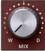
Der MIX WET/DRY-Regler mischt das unverarbeitete trockene Signal mit dem verarbeiteten nassen Signal. MIX befindet sich immer zwischen SWEET und O2. Ein gemischtes Wet/Dry-Signal muss als eine Einheit in den O2-Kreis eingespeist werden, um die Integrität und Absicht des gesamten Plugin-Designs zu bewahren.
