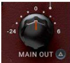
Der MAIN OUT-Regler dient zur präzisen Lautstärkeregelung. Halten Sie die Umschalttaste gedrückt, während Sie MAIN OUT anpassen, damit INPUT DRIVE automatisch kompensiert.
