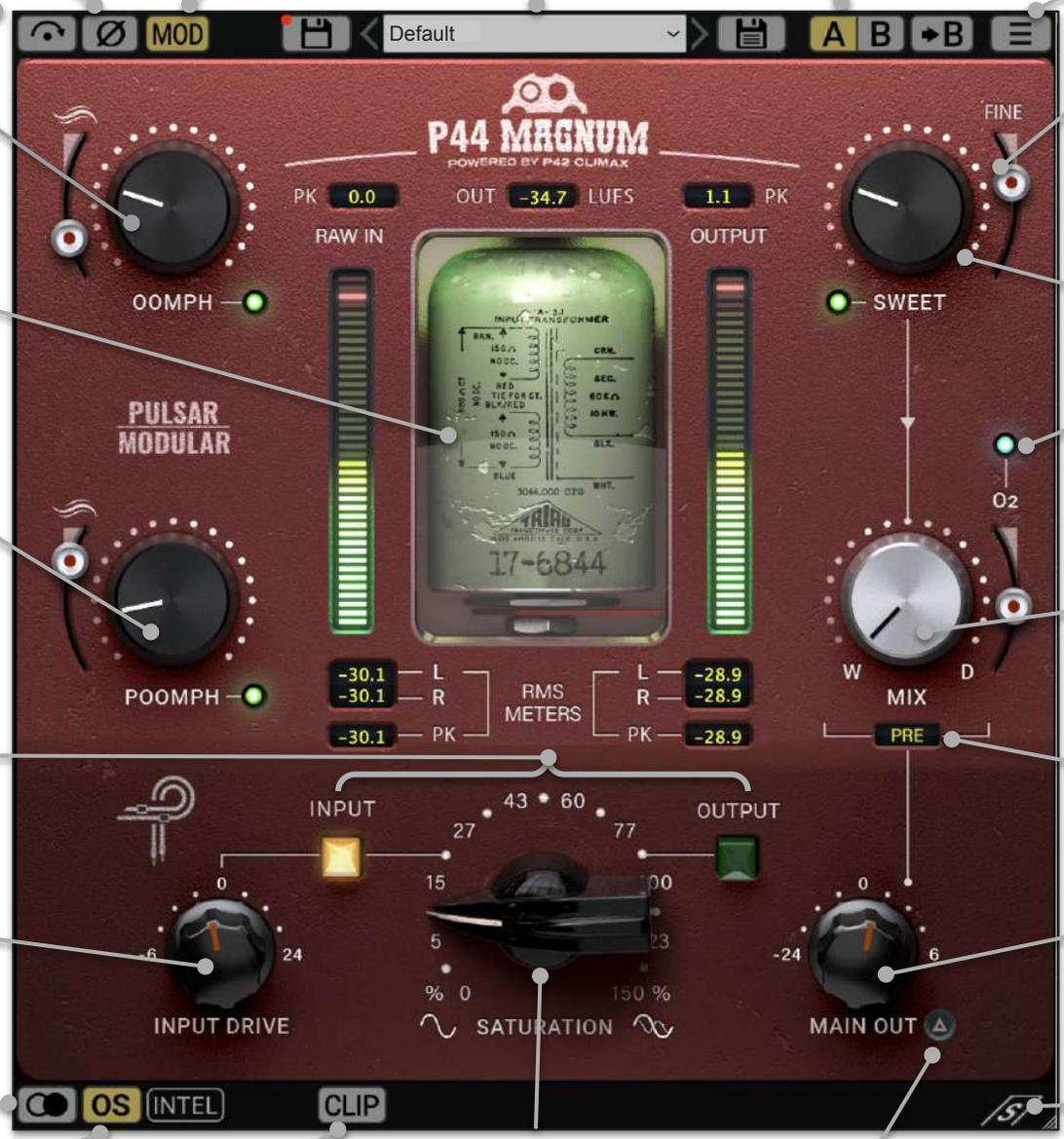
FINE: Passt die Amplitude des Glockenfilterteils des SWEET-Schaltkreises an.
