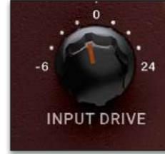
Der INPUT DRIVE-Regler schiebt zusätzliches Eingangssignal in den Transformator, was die Harmonischen erhöht. Verwenden Sie dies zusammen mit dem Sättigungsregler, um ein ideales harmonisches Gleichgewicht einzustellen, das Ihr Material verbessert.
