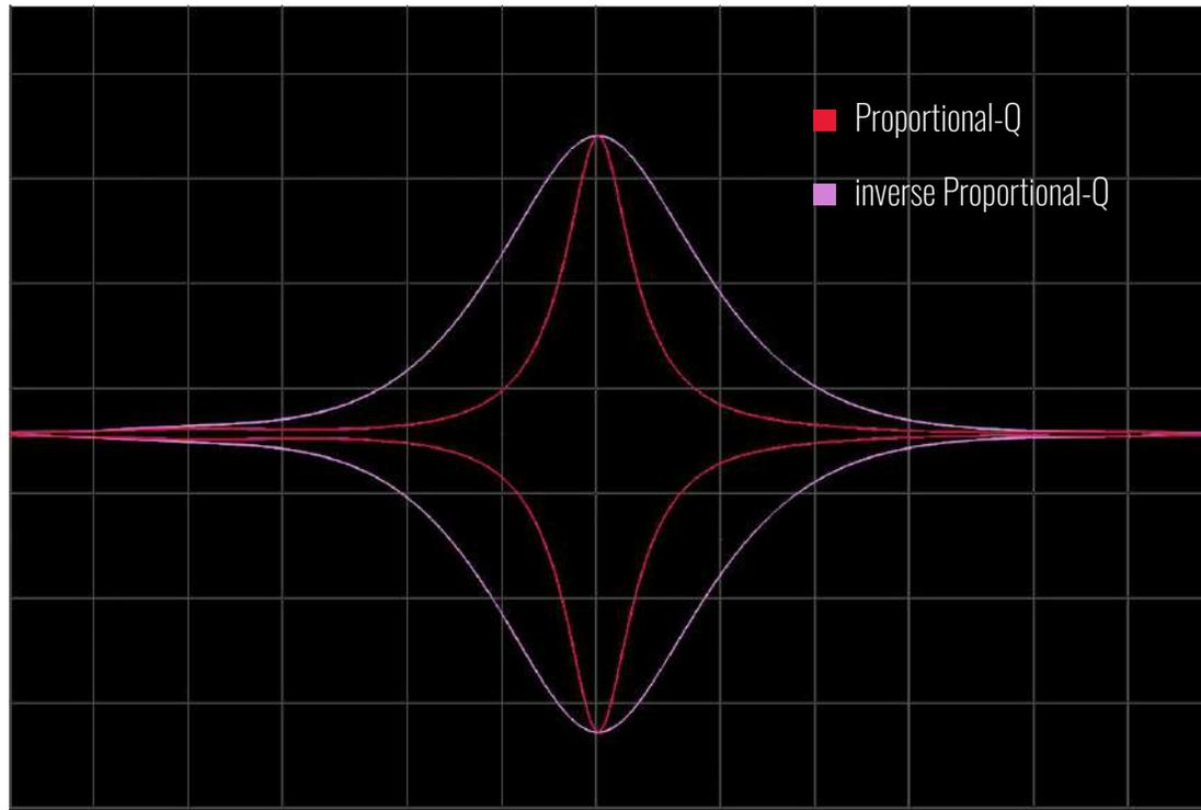
Bei sanften Gain-Einstellungen erweitert ein **Proportional-Q**-Kreis automatisch die Bandbreite, während er bei extremeren Boost-/Cut-Einstellungen die Bandbreite verengt.
