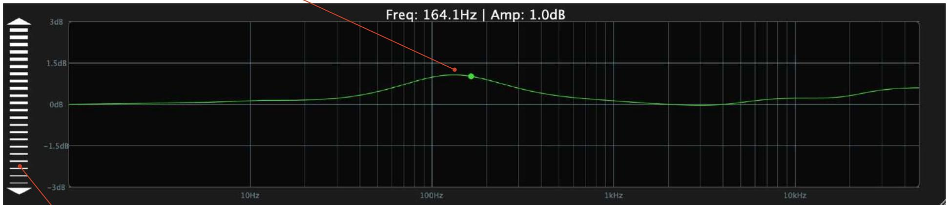
Das Scrollrad funktioniert als schnelle Möglichkeit, das dB-Meter zu vergrößern oder zu verkleinern.
