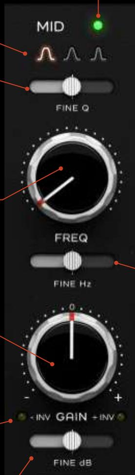
**Resonance HUNT:** Während Sie mit der rechten Maustaste auf den FREQ-Regler oder den FINE Hz-Schieberegler klicken, wird die Q eng und ein mittlerer Boost wird vorübergehend angewendet. Dies ist ein besserer Ansatz als ein Solo-Band-Modus, der das Ohr mit zu abrupten Kontrasten verwirren kann. Verwenden Sie stattdessen Shift-Rechtsklick für einen temporären schmalen Kerbenschritt.
