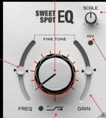
Jeder der Hoch-/Tief-Pfeile (neben dem Ein/Aus-Licht) verschiebt die Mittenfrequenz und biegt die Kurve auf eine Weise, die für jede Frequenzauswahl einzigartig ist.
