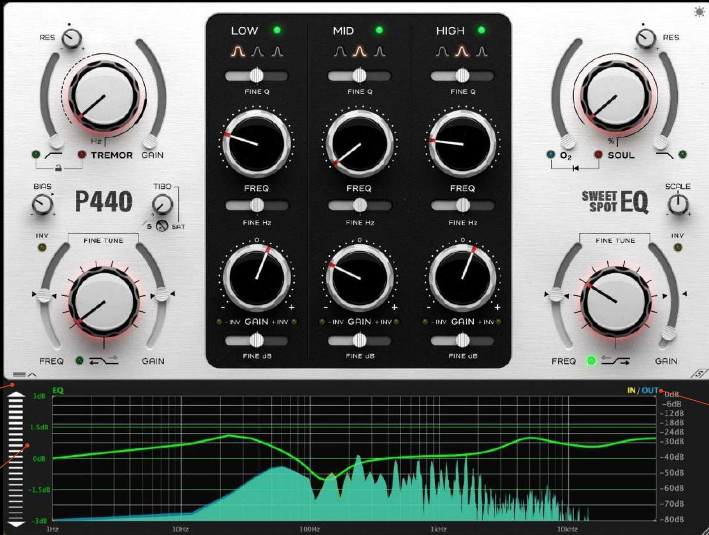
Der Resonanzregler steuert den Q-Faktor—die Schärfe der Resonanz. Der Punkt markiert die Standardposition. Das Symbol + zeigt einen Resonanzpeak an, während das Symbol - eine abgeschwächte Steigung und Phase anzeigt, die eine 6 dB/Oktave-Steigung erreicht. (1-pole).
