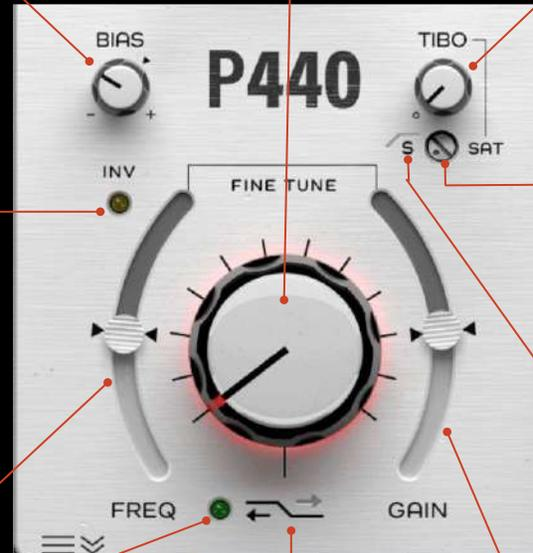
TIBO strafft den Bassbereich, was zu einem kompromisslosen Gefühl von Solidität und Fokus im Zentrum der Bassabbildung führt, ohne das Stereo-Bild zu verändern. Wenn TIBO auf diese Weise verwendet wird, ergänzt es moderne Stereo-Mischtechniken im unteren Preissegment. Der SAT-Trimpotentiometer sorgt für gezielte Bass-Sättigung, die im Haupt-TIBO-Kreis arbeitet und zusätzlichen Biss, Fülle und Präsenz hervorbringt.
