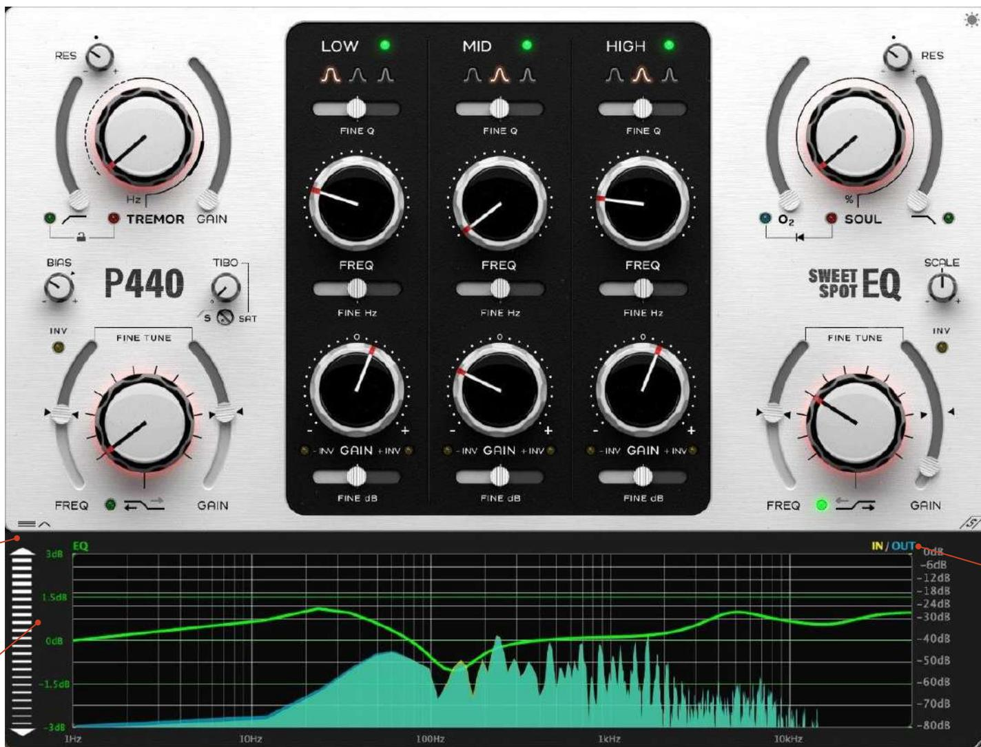
RES ノブはQ ファクター、つまりQ の鋭さをコントロールします。ドットがデフォルト位置を示しています。プラス記号 (+) はレゾナントピークを示し、マイナス記号 (-) は 6 dB/オクターブ (1-pole) のスロープに到達するソフトな傾斜と位相を示します。
