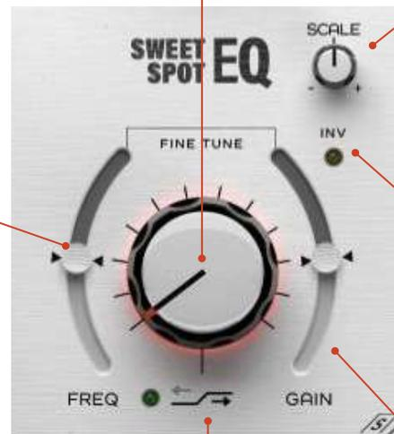
SCALE は、LOW、MID、HIGH バンドの GAIN とファインチューン設定を同時に調整します。中央の位置は0% スケーリングがデフォルトです。SCALE を時計回りに回すことでブーストとカットを増やし、反時計回りに回すことで減衰させることができます。
