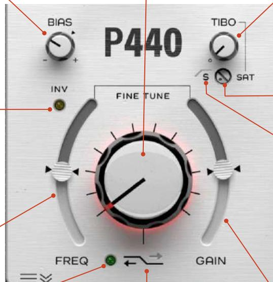
SAT はメインのTIBO 回路に作用するターゲットを絞った、低音のサチュレーションを提供し、追加のグリット、厚み、存在感を引き出します。
