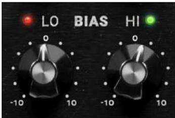
**BIAS-Steuerungen:** Die BIAS-Steuerungen bleiben dem Verhalten von Bandmaschinen treu und bieten separate Kontrolle über niederfrequente und hochfrequente Änderungen, die auftreten, wenn das Band vorgespannt wird.
