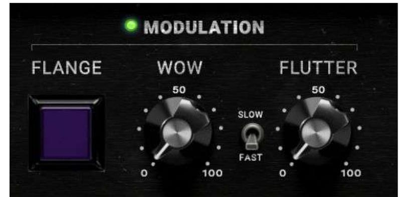
Die 10%-Einstellung kalibriert sich auf die internen vordefinierten Werte für jede Bandformel und Geschwindigkeit. Die Schieberegler passen dann den Effekt basierend auf Prozentsätzen dieser vordefinierten Basislinie an. Langsam spiegelt die typischen Toleranzen von Bandmaschinen wider. Es auf 0% zu setzen, wird das Wow und Flutter des Bandgeräts nicht vollständig stoppen. In diesem Fall müssen Sie den Modulationskreis ausschalten.
