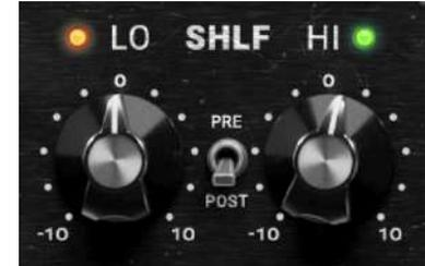
Die PRE-Position ermöglicht Frequenzganganpassungen, bevor die Sättigungs- und Kompressionseigenschaften des Bandes wirksam werden, was beeinflusst, wie das Band auf verschiedene Frequenzen reagiert. Zum Beispiel kann das Anheben der Höhen vor dem Band zu einem ausgeprägteren Bandkompressionseffekt bei diesen Frequenzen führen, während das Absenken der Tiefen Pre-Tape kann helfen, übermäßigen Bassaufbau in der Sättigungsphase zu kontrollieren.
