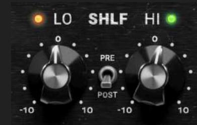
POSTポジションは、テープがそのキャラクターを与えた後にトーンバランスを調整する方法を提供します。 これは、失われた高音域を復元したり、誇張された倍音を抑えたり、テープ自体が信号にどのように反応するかに影響を与えずに微妙な音色調整を行ったりするのに役立ちます。
